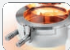
2. 將壓模片固定夾於受熱槽。
