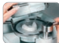
5. 加熱時間結束，機器發出警示嗶聲，洩壓，取出成型牙套。
